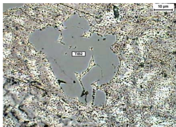
Rys. 3. Mikrofotografia powierzchni próbki kompozytu Al/ \text{TiB}_2 wytworzonego metodą SHS
